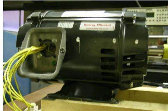
Fig. 2: Motor B (4 poles DP machine).
